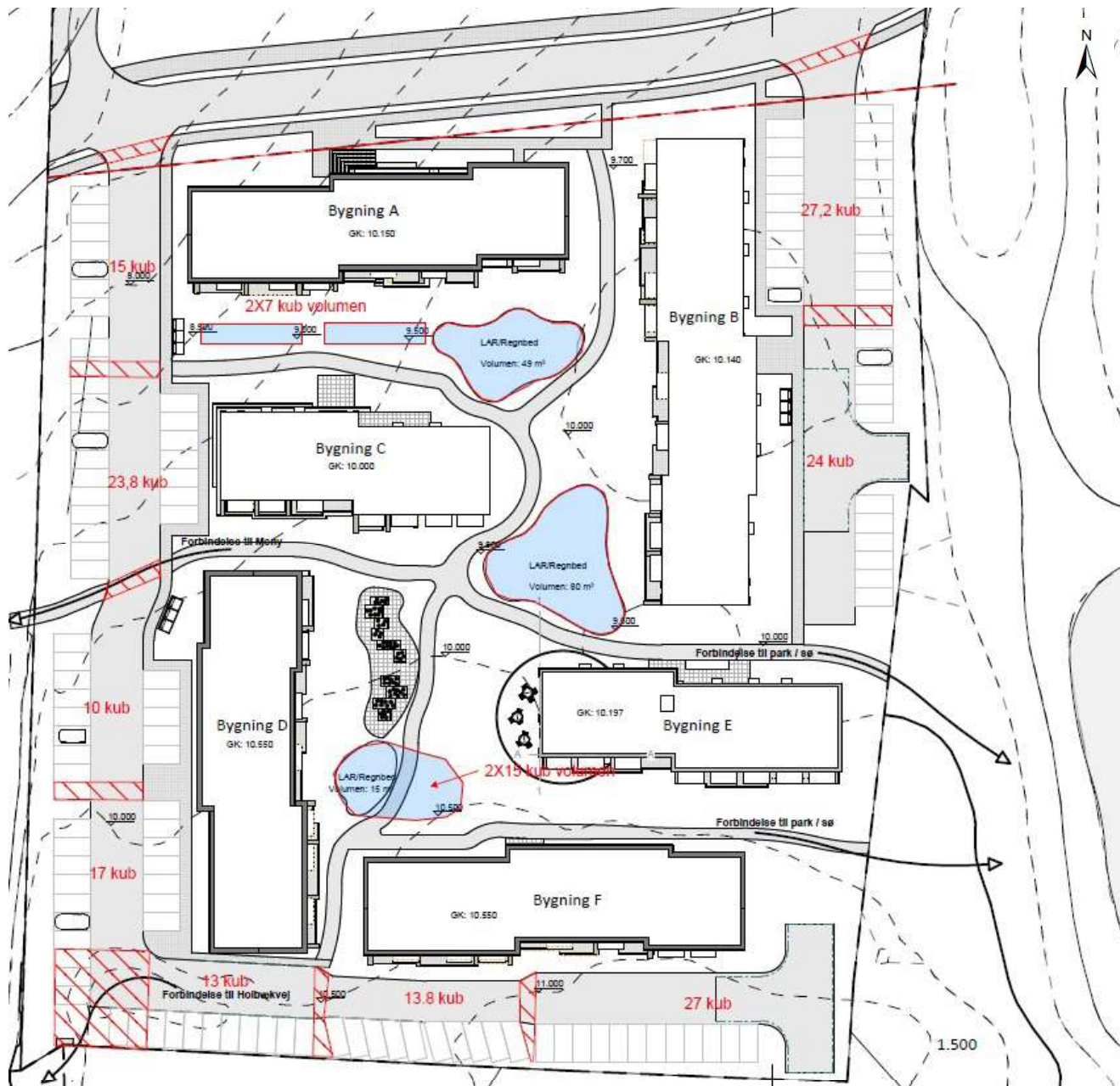
Figur 1.2: Udsnit af foreløbig situationsplan med forslag til bassiner (blå) og opstuvning på kørebane (rød skravering).
